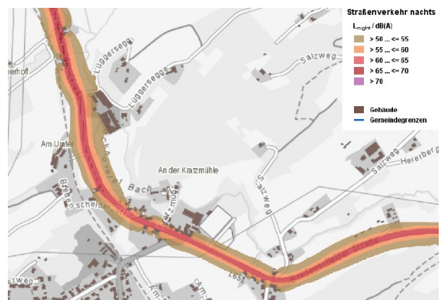
Abbildung 13: Darstellung der Lärmbelastung in der Nacht auf der L 651 zwischen der Nordstraße und der Stadtgrenze Sprockhövel (Teil 2)
