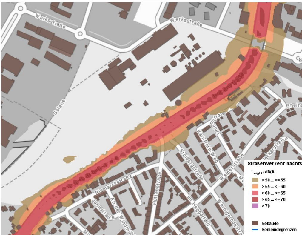
Abbildung 19: Darstellung der Lärmbelastung in der Nacht auf der L 705 zwischen der Martin-Luther-Straße und Am Büchenschütz (Teil 2)
