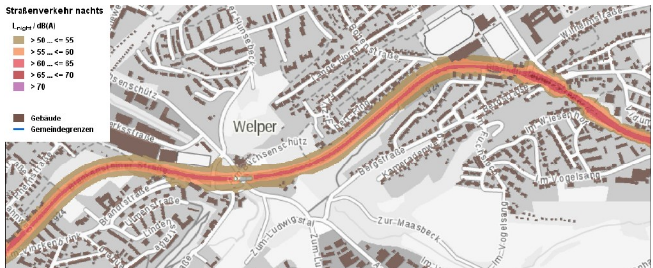
Abbildung 27: Darstellung der Lärmbelastung in der Nacht auf der L 924 zwischen dem Lahnweg und der Stadtgrenze Witten (Teil 1)
