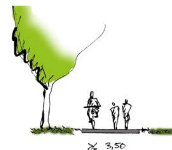
Abb. 1: Gemeinsamer Fuß- und Radweg
