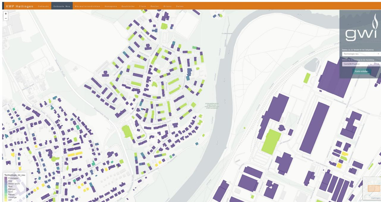
Bei Zentralheizungen für mehrere benachbarte Gebäude erhält nur ein Gebäude die Technologie „Gas“ und die übrigen „Sonstige“. Dieses Gebäude erhält auch den kompletten Wärmebedarf zugeordnet.
